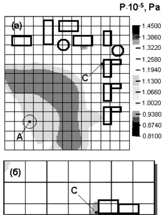
Рис. 6. Распределение давления в плоскостях: а – XOZ у земли, б – YOZ
