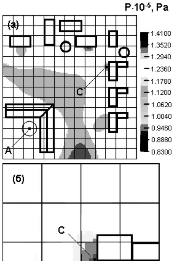
Рис. 11. Распределение давления в плоскостях: а – XOZ у земли, б – YOZ
