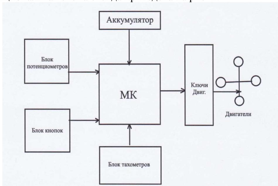
Рис. 1. Функциональная схема устройства
